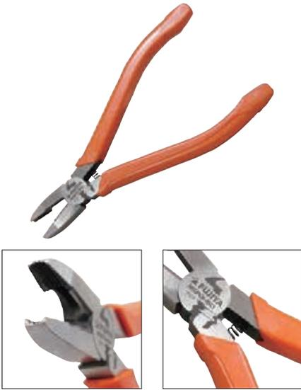
潰れたネジや錆びついたネジ、特殊なネジもしっかり掴んで回します。ネジ掴んで緩める方向に回すと、先端の特殊溝形状がネジにがっちり食い込みネジが回せます。
