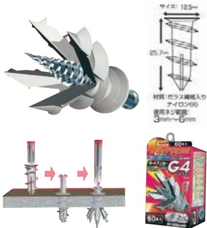
最大の特徴は、先端先割れ4分割方式の採用です。石膏ボード内で4つに割れることで、360度均等に力を分散し、従来方式のアンカー「2つ割れ」「1つ割れ」等と比べ、石膏ボードにガッチリ食い込み、アンカーを固定します。
