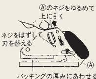
カーペットの厚みに合わせて、本体の調整スロットを開き、ループパイルを挟み込みます。(パネで閉じてループパイルの目と目の間にブレードが入ります)
