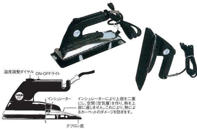
インシュレーターにより上部を二重にし、空間(空気層)を作り、熱を上部に通しません。これにより、熱によるカーペットのダメージを防ぎます。
