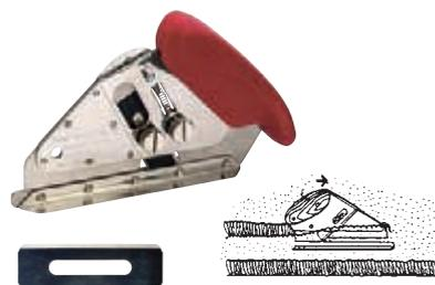
ループパイルカーペットの厚さに合わせて調整スロットの開き具合を調節し、パイルの根元で正確にカットすることができます。2枚の刃を使い分けるように設計されています。
