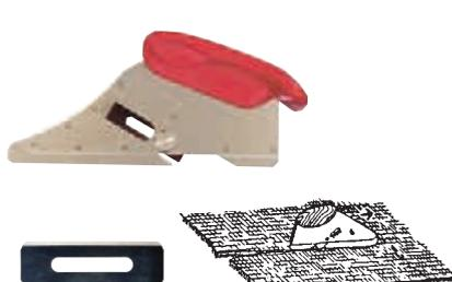
クッションバックなど厚いカーペットを表面からカット。ジュートックカーペットを裏からカット。2枚の刃を使い分けてカーペットを正確にカットすることができます。
