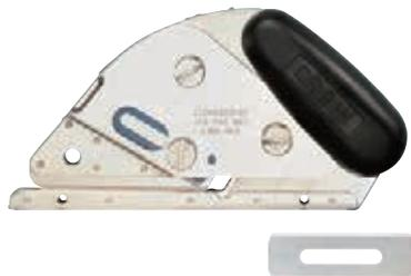
カーペットの厚みに応じて厚み調整ができます。左右の2枚の刃を使いわけることにより美しくカットすることができます。
