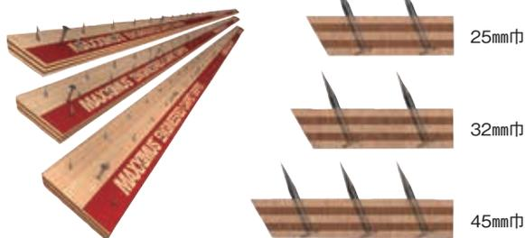
壁際の面は、上端を少しそいでカーペットを巻き込みやすくし、また外れないように内側に斜めにカットされています。ピンはゴールドメッキで錆びに強く、カーペットを引っかけるのに理想的な角度(60度)で撃ち込まれています。
