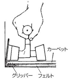
従来のステアツールと比べ、作業能率が数倍早く、グリッパーと巾木の隙間にカーペットを差し込むと同時に、ジュートに釘をしっかりと固定します。グリッパー釘がカーペットの表面に出てしまうような場合、再度上から押さえて下さい。金槌でステアツールが叩きにくいガラス面や、巾木が壁面よりはいり込んでいる場合、大変効果を発揮します。
